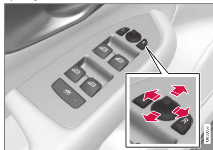
Ovládací prvky vnějších zpětných zrcátek.
