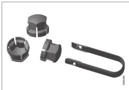
Nástroj pro sejmутí plastových krytek šroubů kol.
