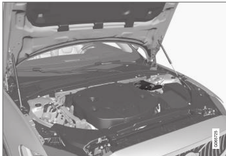
Pomocná baterie se nachází v motorovém prostoru.
