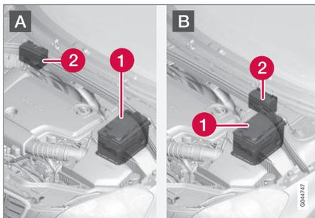
A: Automóvil con volante a la izquierda. B: Automóvil con volante a la derecha. (1). Batería de arranque<sup>16</sup> (2). Batería de apoyo.
