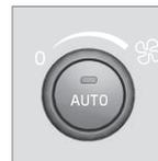
Gire el mando para aumentar o reducir la velocidad del ventilador. Si se selecciona **AUTO**, la velocidad del ventilador se regulará de forma automática (p. 137) y se desconectará la velocidad
