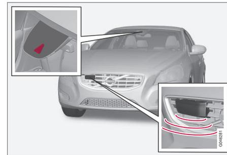
Sensor de cámara y de radar<sup>22</sup>.
