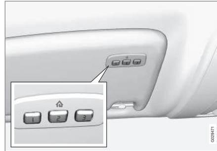
HomeLink®<sup>24</sup> es un mando a distancia programable que puede controlar hasta tres dispositivos diferentes (por ejemplo, la puerta del garaje, el sistema de alarma, la iluminación exterior e interior, etc.) y utilizarse por tanto en lugar de los mandos a distancia correspondientes.
