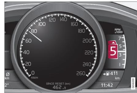
Cuatro de instrumentos "Digital" con indicador de cambio de marcha.
