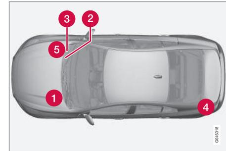
Ubicación de las cajas de fusibles y relés en automóviles con volante a la izquierda. Si el automóvil lleva el volante a la derecha, cambia de lado la caja de fusibles y relés situada debajo de la guantera.
