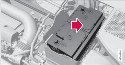
1. Coloque la batería en la caja de la batería.
