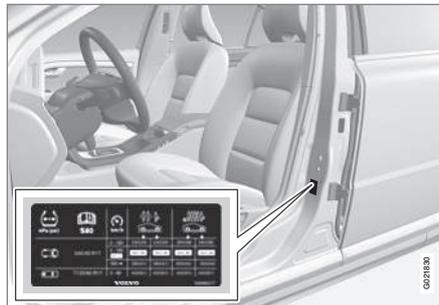
La placa de presión de neumáticos situada en el montante de la puerta del lado del conductor (entre la puerta delantera y la trasera) especifica la presión que deben tener los neumáticos en diferentes condiciones de carga y velocidad. Estos datos se indican también en la tabla de presiones de neumáticos, véase Neumáticos - presiones de inflado aprobadas (p. 451).
