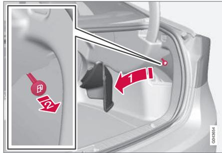
1. Abra o retire la tapa lateral en el maletero (en el mismo lado que la tapa del depósito) y busque un cable de color verde con balanza.
