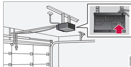
4. Busque el "botón de memorización<sup>25</sup>" en el receptor de, por ejemplo, la puerta del garaje, que suele estar situado cerca de la fijación de la antena en el receptor.
