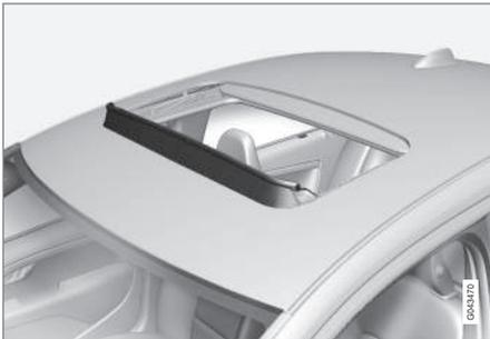
El techo solar está provisto de un deflector de aire que se levanta cuando el techo solar está abierto.
