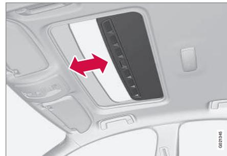
Si se mantiene pulsado el botón de cierre, se cierra el techo solar y todas las ventanillas, véase Mando a distancia - funciones (p. 166) y Cierre y apertura - en el interior (p. 179). Las puertas y el maletero se cierran. Si es necesario interrumpir el movimiento de cierre, pulse de nuevo el botón de cierre.
