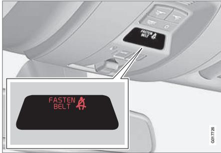
El aviso acústico depende de la velocidad y, en algunos casos, del tiempo. La señal luminosa se puede ver en la consola del techo y en el cuadro de instrumentos (p. 62).
