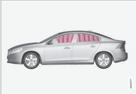
La cortina inflable IC (Inflatable Curtain) forma parte del sistema SIPS (p. 36) y el sistema de airbags (p. 32). Va montado a lo largo de ambos lados del techo interior y contribuye a proteger al conductor y a los pasajeros situados en los asientos exteriores del vehículo. En caso de una colisión de suficiente intensidad, los sensores reaccionan y el airbag de techo lateral se infla.
