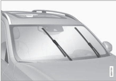
Torkarblad i serviceläge.
