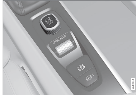
Startvredet i tunnelkonsolen.
