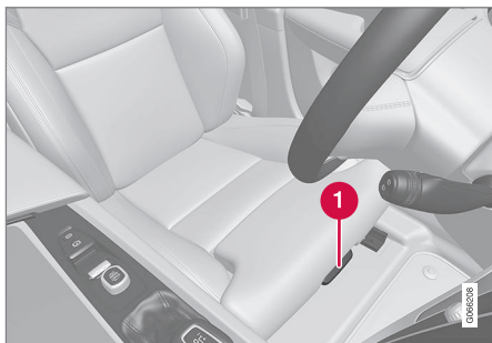
Reglage för dynjustering.
