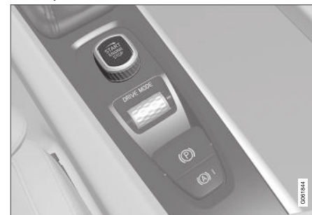
Ручка запуска в тоннельной консоли.
