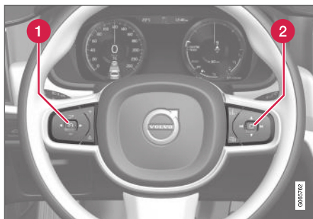
Набор кнопок и лепестки* на рулевом колесе.
