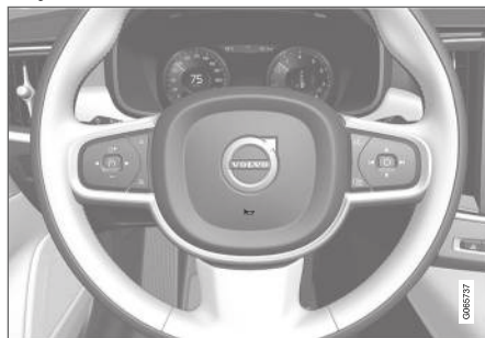
Сигнальный рожок расположен в центре рулевого колеса.
