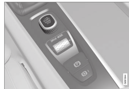
Ручка запуска в тоннельной консоли.
