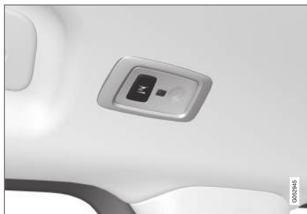
В автомобиле с панорамной крышей* установлены два блока ламп – на потолке с каждой стороны.
