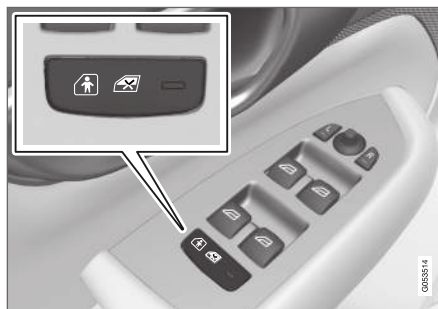
Кнопка для активирования и отключения электрической блокировки.
