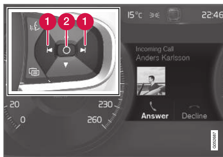
Пример сообщений на дисплее водителя 7 и правый набор кнопок на рулевом колесе.
