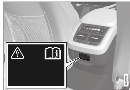
Электрическое гнездо в тоннельной консоли, заднее сиденье.
