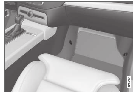
Расположение точек крепления для переднего сиденья.
