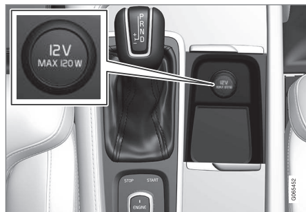
12 V strømuttak i tunnelkonsoll, forsete.
