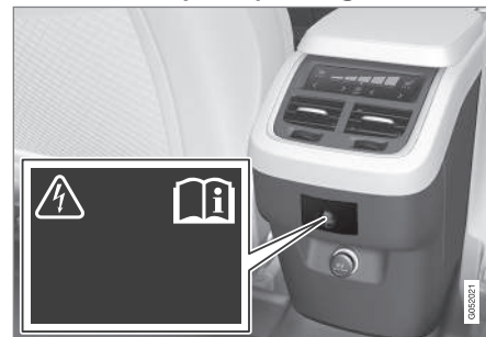
Strømuttak i tunnelkonsollen, andre seterad.
