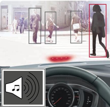
Le système optionnel de détection des piétons et des cyclistes avec freinage automatique complet comporte une fonction qui permet de détecter les piétons et applique les freins pour ralentir ou arrêter le véhicule.
