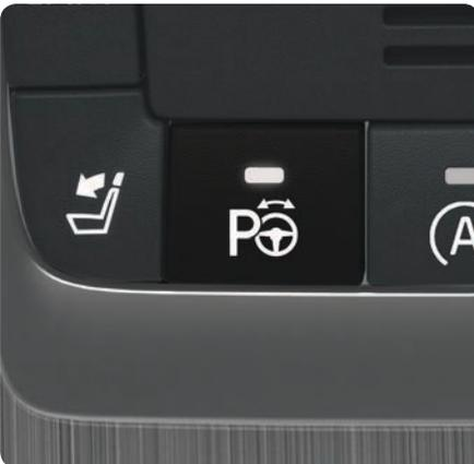
PAP (système d'aide au stationnement) détermine si l'espace d'un emplacement de stationnement est suffisant pour votre véhicule et aide à manœuvrer dans l'emplacement. Le conducteur doit surveiller la zone environnant le véhicule, sélectionner les rapports, réguler la vitesse du véhicule et freiner.
