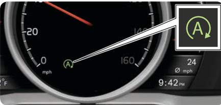
**Arrêt automatique :** Freiner jusqu'à l'arrêt du véhicule et maintenir la pédale de frein enfoncée.
