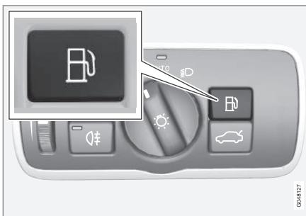
Avec le contact coupé, appuyer sur le bouton du panneau d'éclairage et le relâcher pour déverrouiller le volet du réservoir de carburant. Veuillez noter que le volet reste déverrouillé jusqu'à ce que le véhicule commence à avancer. On entend un clic lorsqu'il se verrouille de nouveau.
