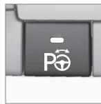
1. Activer le système PAP en appuyant sur le bouton de la console centrale et au besoin, ralentir jusqu'à une vitesse inférieure à 20 mph (30 km/h).
