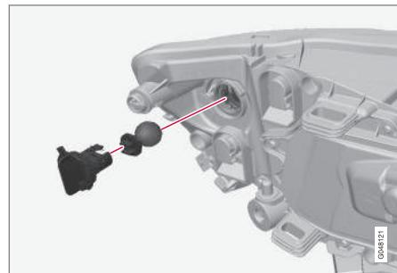
1. Déposer le boîtier de phare du véhicule (voir Ampoules - boîtier de phare (p. 360)).
