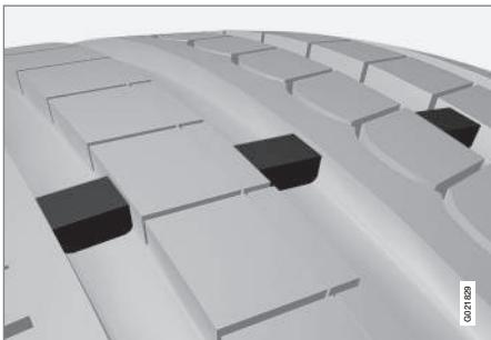
Les lettres **TWI** sont imprimées sur le flanc du pneu. Lorsqu'il ne reste plus qu'environ 1,6 mm (1/16 po) de bande de roulement, les bandes deviennent visibles et indiquent qu'il faut remplacer le pneu. Un pneu dont l'épaisseur de la bande de roulement est inférieure à 1,6 mm (1/16 po) offre une très mauvaise adhérence.
