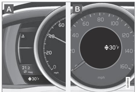
Emplacement du capteur de température ambiante, A : tableau de bord numérique\*, B : tableau de bord analogique
