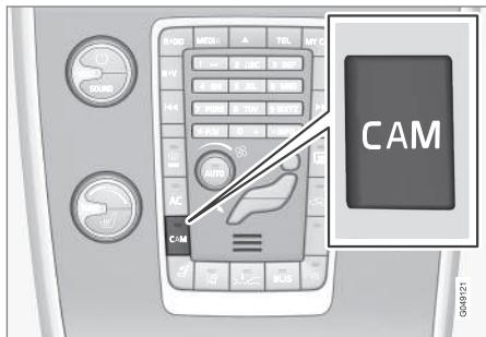
La PAC est activée lorsqu'on déplace le levier de vitesses à **R** si le système est sélectionné dans le système de menu **MY CAR** ou si on appuie sur le bouton **CAM** dans la console centrale. Voir My Car (ma voiture) - introduction (p. 77) pour une description du système de menu.
