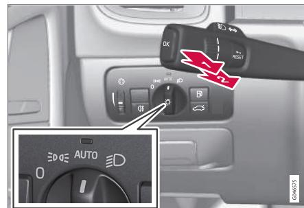
Commutateur de phares et levier de commandes au volant
