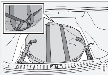
tourner la poignée située sur le sac de la roue de secours en direction du siège arrière. Fixer les crochets de la courroie cousue dans les oeillets de chargement. Fixer la longue courroie dans l'un des oeillets de chargement, enrouler la courroie autour de la roue de secours et à travers la poignée inférieure. Fixer la courroie courte sur la longue courroie. Fixer dans l'autre oeillet de chargement et serrer.
