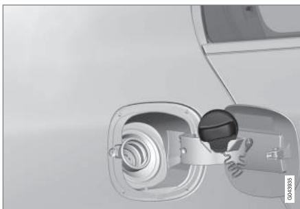
La vapeur d'essence se dilate par temps chaud. Ouvrez le bouchon du réservoir de carburant lentement.
