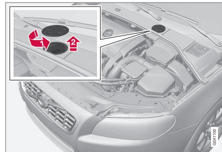
Emplacement du réservoir du liquide de frein
