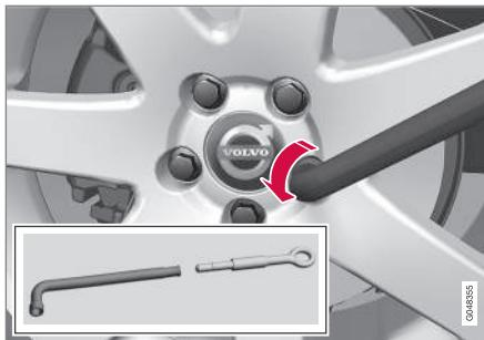
6. Pendant que le véhicule est toujours au sol, desserrer les boulons en pressant vers le bas (sens antihoraire) et tourner de  $\frac{1}{2}$  - 1 tour à l'aide du démonte-roue/de l'anneau de remorquage.
