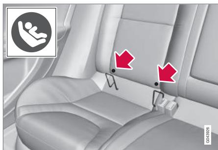
Les symboles figurant sur le revêtement du dossier indiquent les positions des ancrages ISOFIX/LATCH comme illustré. Pour accéder aux ancrages, s'agenouiller sur le coussin du siège et les repérer au toucher. Toujours suivre les directives d'installation du fabricant du siège pour enfant et utiliser à la fois les ancrages inférieurs ISOFIX/LATCH et les attaches supérieures (p. 61) dans la mesure du possible.
