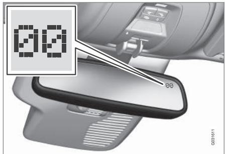
Rétroviseur avec boussole.
