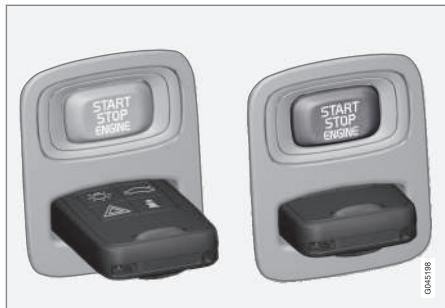
2. Afin de désactiver l'alarme, insérer la clé télécommande dans la fente d'allumage (également sur les véhicules équipés du démarrage sans clé en option).
