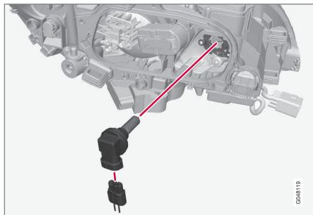
1. Déposer le boîtier de phare du véhicule (voir Ampoules - boîtier de phare (p. 360)).
