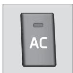
Lorsque le témoin dans le bouton est allumé, la climatisation est automatiquement commandée. L'air entrant est alors rafraîchi ou réchauffé et déshumidifié. Lorsque le témoin dans le bouton est éteint, la climatisation est désactivée. Les autres fonctions continuent d'être commandées automatiquement. Lorsque le dégivrage maximum (p. 138) est sélectionné, le système de climatisation est réglé à la vitesse maximale du ventilateur et déshumidifie le plus rapidement possible l'habitacle.
