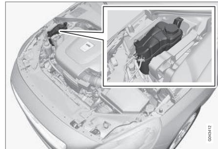
*Emplacement du réservoir de liquide de refroidissement*
