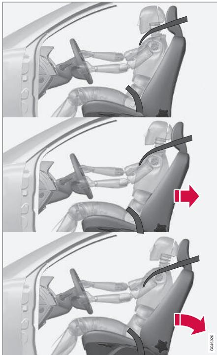
En cas de collision par l'arrière, les charnières et les supports des dossier des sièges avant sont conçus pour changer légèrement de position, afin de permettre au dossier et à l'appuie-tête de mieux soutenir la tête de
