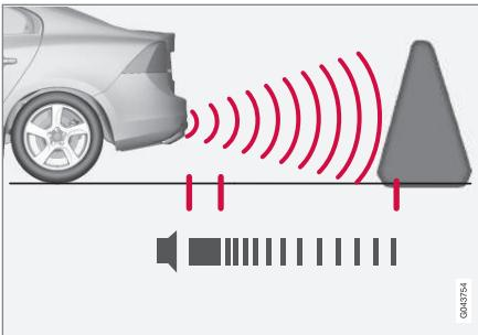
La distance mesurée à l'arrière du véhicule est d'environ 1,5 mètre (5 pieds). Le signal est transmis par les haut-parleurs arrière.
