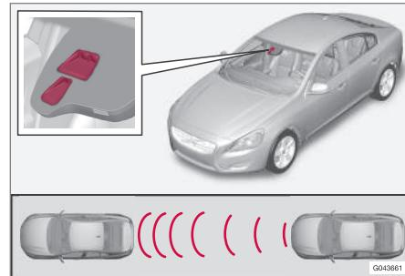
Emplacement du capteur laser dans le pare-brise<sup>5</sup>
