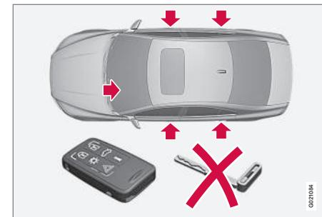
Points de verrouillage/déverrouillage en mode voiturier
