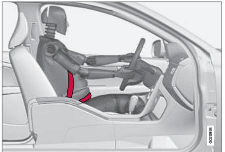
La ceinture doit être placée près du corps, le baudrier traversant le creux de la poitrine jusqu'au côté de l'abdomen. La partie ventrale de la ceinture doit être placée à plat au-dessus du haut des cuisses et le plus bas possible sous le ventre. Elle ne doit jamais être déplacée vers le haut. Éliminer tout mou dans la ceinture et s'assurer que celle-ci est bien ajustée au corps, sans entortillements.
