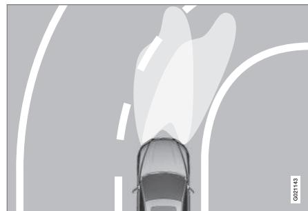
Modèle de phare avec la fonction Active Bending Light (phares directionnels) désactivée (à gauche) et activée (à droite)
