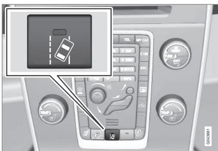
On peut activer ou désactiver le LKA en appuyant sur le bouton de la console centrale. Un témoin dans le bouton s'allume lorsque le système est activé.
