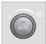
tourner la commande dans le sens horaire pour augmenter la vitesse du ventilateur et dans le sens antihoraire pour la diminuer. Si la commande **AUTO** (p. 137) est sélectionnée, la vitesse du ventilateur sera contrôlée automatiquement et cela neutralisera le réglage manuel.
