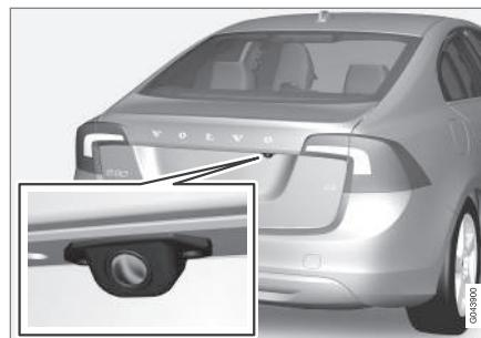
Le conducteur voit ce qu'il y a derrière le véhicule et si une personne ou un animal apparaît soudainement du côté.
