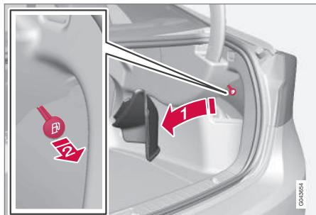
1. Ouvrir la trappe latérale dans le coffre (du même côté que le volet du réservoir de carburant).
