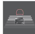
On peut choisir des intervalles de temps différents qui apparaîtront au tableau de bord<sup>2</sup> sous forme de 1 à 5 barres horizontales. Plus le nombre de barres est élevé, plus l'intervalle de temps est long. Une barre représente un intervalle de temps d'environ 1 seconde ; 5 barres représentent environ 3 secondes.
