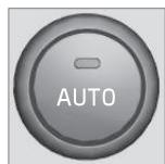
Si vous sélectionnez une ou plusieurs fonctions manuelles, les autres fonctions continuent d'être commandées automatiquement. Le capteur de qualité de l'air (p. 131) est activé et tous les réglages manuels sont désactivés lorsqu'on appuie sur **AUTO**. Le message **CLIM AUTOMATIQUE** apparaît dans l'affichage.
