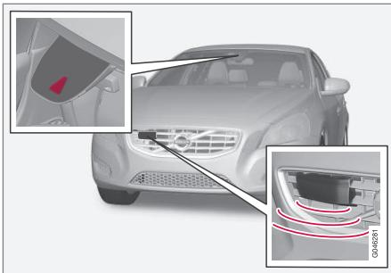
Caméra et capteur radar<sup>6</sup>.
