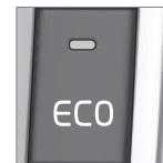
Si la fonction ECO \* (ECO\* (p. 283)) est activée, le moteur du véhicule peut s'arrêter automatiquement avant l'arrêt complet du véhicule.
