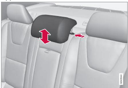
L'appuie-tête central doit être réglé en fonction de la taille du passager. Bien régler l'appuie-tête pour qu'il soutienne la tête du passager.
