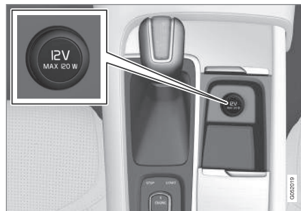
12 V elektrības kontaktlīgšana tuneļkonsolē, pie priekšējiem sēdekļiem.
