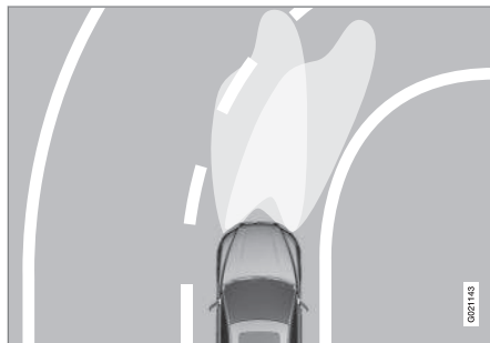
Foco dos faróis com a função desactivada (esquerda) e activada (direita).
