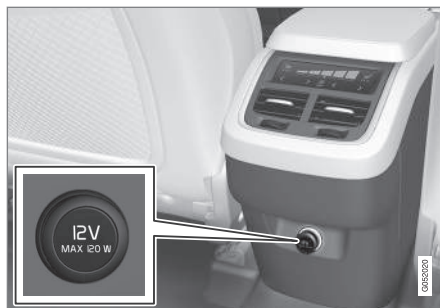
12 V-uttak i tunnelkonsoll, andre seterad.
