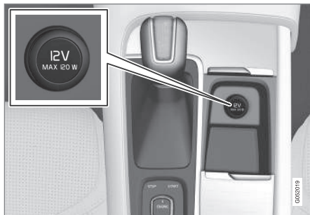
12 V strømuttak i tunnelkonsoll, forsete.
