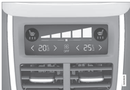
Setevarmeindikasjon og brytere på klimapanelet bak tunnelkonsollen.
