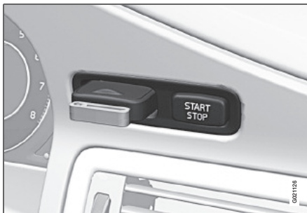
Contactslot met transpondersleutel en start-/stopknop (zie 65 voor meer informatie).
