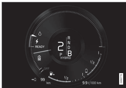
Vozidlo generuje proud do baterie a baterie se dobíjí, když se např. mírně sešlápne brzdový pedál nebo když se při sjíždění svahu brzdí motorem.
