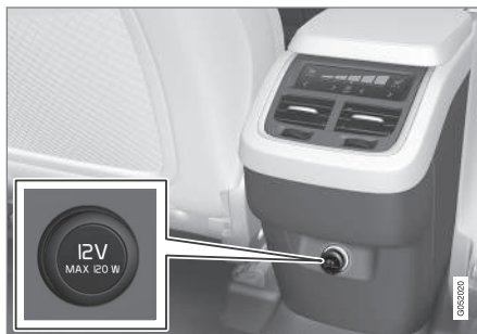
12V elektrická zásuvka v tunelové konzole, druhá řada sedadel.
