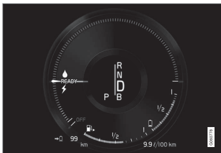
Vozidlo se nastartuje, ale nejede, výkon není zapotřebí.
