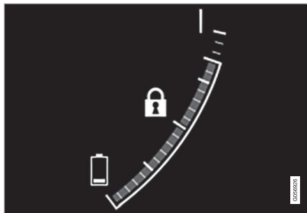
Vozidlo generuje proud do baterie a baterie se dobíjí, když se např. mírně sešlápne brzdový pedál nebo když se při sjíždění svahu brzdí motorem.
