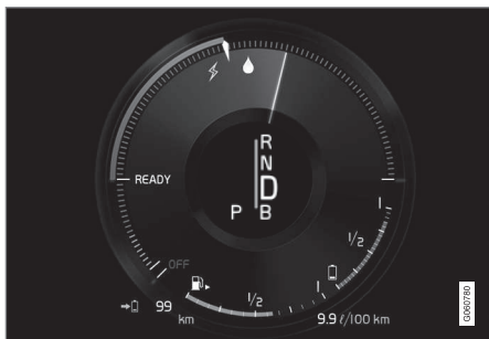
Elektromotor není schopen zajistit požadovaný výkon a nastartuje se motor s vnitřním spalováním.
