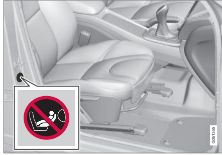
Εναλλακτική 2: θέση της ετικέτας αερόσακου στην κολόνα της πόρτας συνοδηγού. Η ετικέτα είναι ορατή όταν η πόρτα του συνοδηγού είναι ανοικτή.
