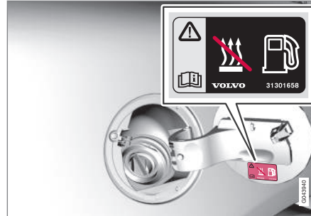
Varningsdekal på tankluckan.
