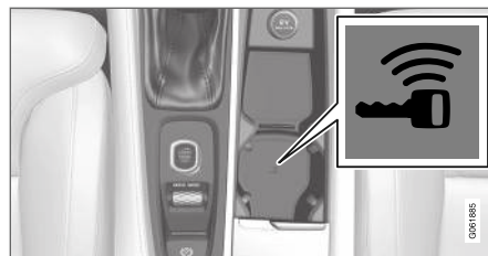
Atsarginės skaityklės vieta tunelio valdymo pulte.
