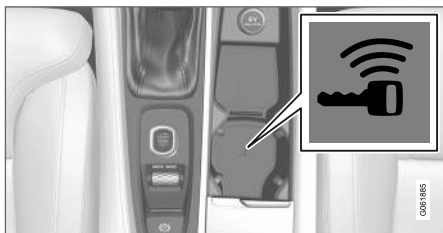
Atsarginės skaityklės vieta tunelio valdymo pulte.
