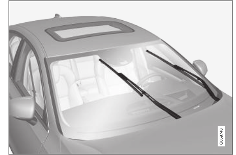
Valytuvo šluotelės aptarnavimo padėtyje.
