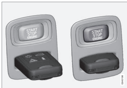
Contactslot met transpondersleutel uitgetrokken/ingedruwd.
