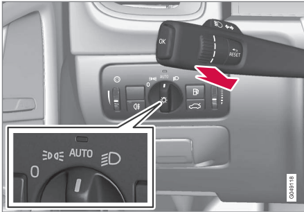
Kontaktarm og lyspanelets knap i position AUTO .
