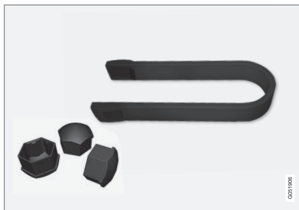
Værktøj til at fjerne hjulboltenes plastkapsler.
