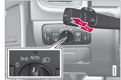
Kontaktarm og lyspanelets knap.
