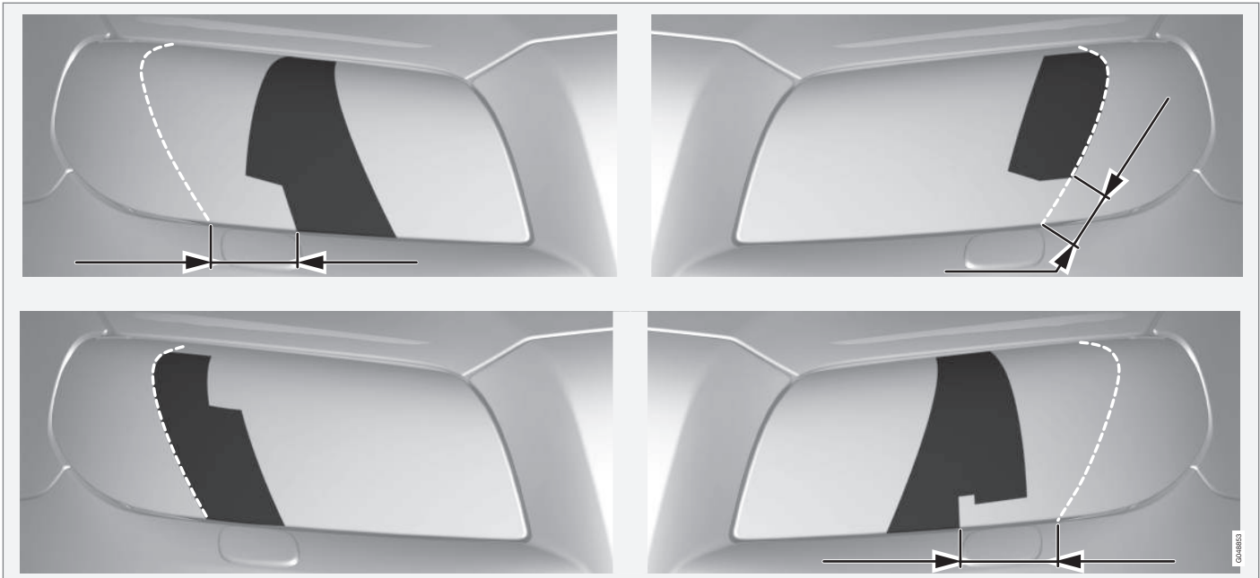
Övre raden: vänsterstyrd bil, mallar A och B. Nedre raden: högerstyrd bil, mallar C och D.
