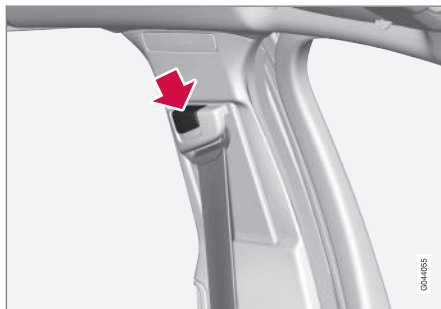
Saugos diržo aukščio reguliavimas. Paspauskite mygtuką ir vertikaliai judinkite diržą. Nustatykite viršutinį diržo fiksavimo tašką kiek įmanoma aukščiau, tačiau diržas neturi trintis į Jūsų kaklą.
