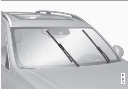
Pióra wycieraczek w pozycji serwisowej.
