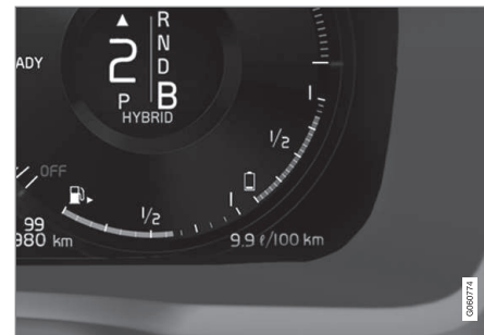
Wskaźnik akumulatora układu hybrydowego.
