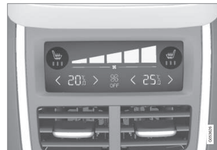
Wskazanie i przyciski podgrzewania siedzeń na panelu klimatyzacji z tyłu konsoli między fotelami.
