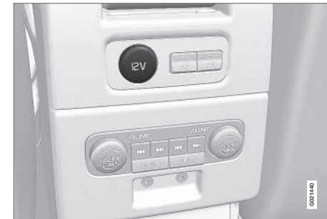
Preso da 12 V nel tunnel, sedile posteriore.
