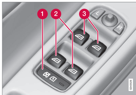
Pannello di comando nella portiera del conducente.
