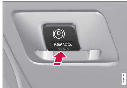
Comando del freno di stazionamento - applicato.
