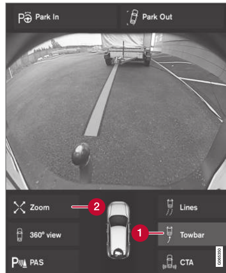
Crochet d'attelage avec ligne indicatrice.
