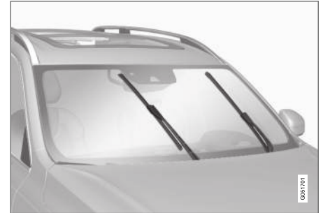
Balais d'essuie-glace en position d'entretien.
