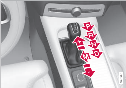
Overzicht grote schakelhendel en schakelstanden.
