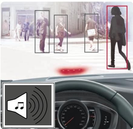
Vozidlo je vybaveno systémem varování před kolizi s automatickou aktivací brzd a detekcí chodců. Tento systém dokáže v případě vozidel, cyklistů a chodců varovat, přibrzdit resp. zastavit.
