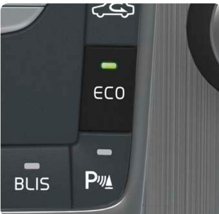
Durch Drücken von **ECO** aktivieren Sie ein Fahrprogramm, das vorrangig auf einen möglichst niedrigen Kraftstoffverbrauch abgestimmt ist und folgende Änderungen beinhaltet:
