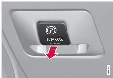
Przełącznik hamulca postojowego – wyłączenie.
