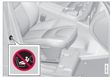
Alternatywa 2: Umieszczenie naklejki poduszki powietrznej na słupku drzwi po stronie pasażera. Naklejka poduszki powietrznej jest widoczna po otwarciu drzwi pasażera.
