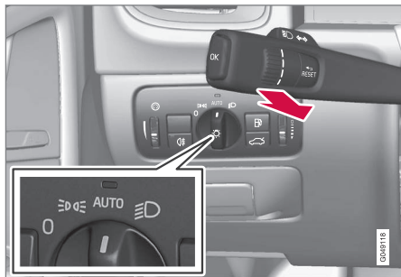
Przełącznik przy kierownicy i pokrętko przełącznika świateł w pozycji AUTO .
