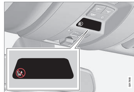
Sygnalizacja włączenia czołowej poduszki powietrznej po stronie pasażera.
