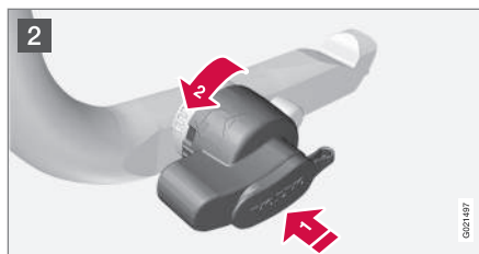
2 Wcisnąć gałkę blokady 1 i obrócić w lewo 2 , aż rozlegnie się odgłos zatrzaśnięcia.
