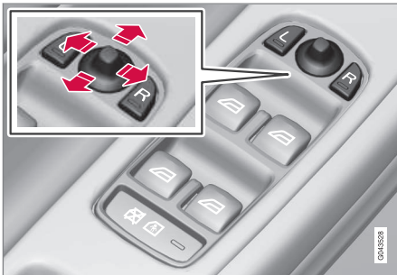
Przełączniki sterujące zewnętrznymi lusterkami wstecznymi.
