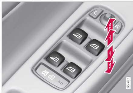
Bedieningsknoppen elektrisch bediende zijruiten.
