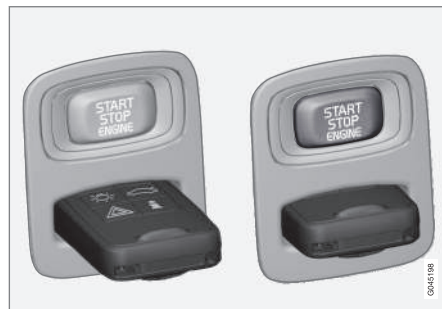
Blocchetto di accensione con chiave telecomando estratta/inserita.
