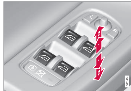
Керування вікнами з електропідійомниками.
