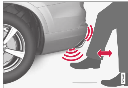
Sensoren er placeret til venstre for midten i kofangeren.
