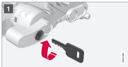
1 Вставьте ключ и поверните по часовой стрелке до незапертого положения.
