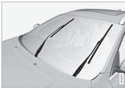
Balais d'essuie-glace en position d'entretien.
