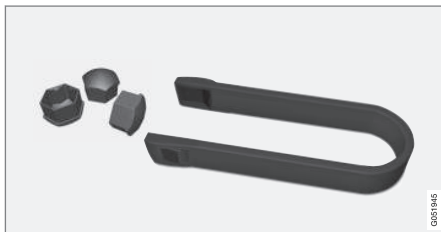
Verktøy til fjerning av plasthetter på hjulmutrene.
