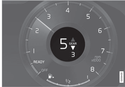
Girindikator på 12-tommers førerdisplay.
