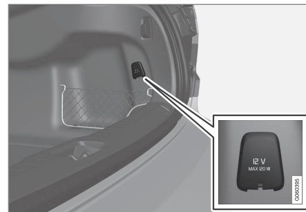
12 V strømuttak i bagasjerom*.
