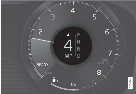
Girindikator på 12-tommers førerdisplay.
