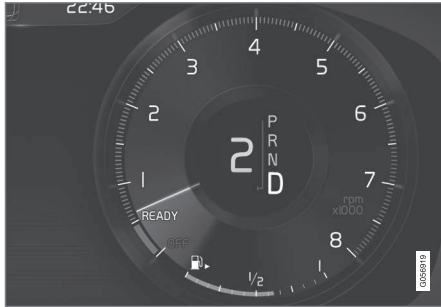
Førerdisplayet ved giring med rattspaker.
