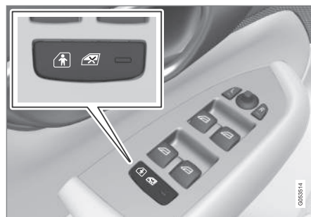
Knapp for elektrisk aktivisering/deaktivisering.
