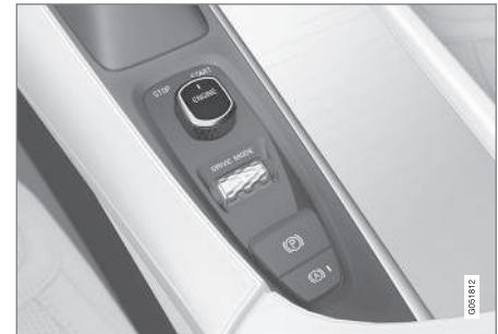
Startbryteren i tunnelkonsollen.
