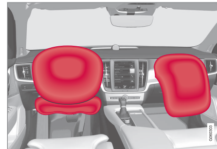
Kollisjonsputer på fører- og passasjerside 1 .
