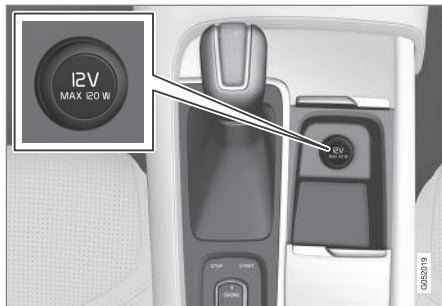
12 V strømuttak i tunnelkonsoll, forsete.
