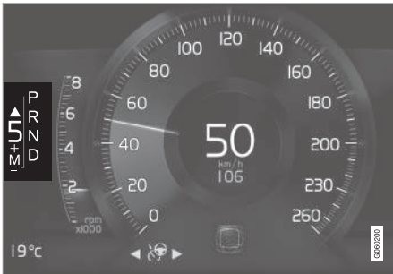
Girindikator på 8-tommers førerdisplay.
