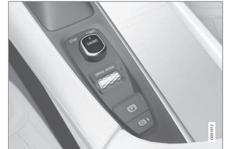
Startbryteren i tunnelkonsollen.
