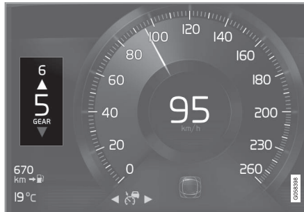
Girindikator på 8-tommers førerdisplay.
