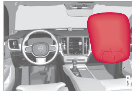
Airbag nel sedile anteriore sul lato passeggero.
