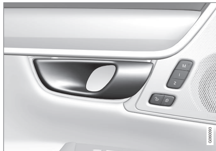
Maniglia per lo sbloccaggio alternativo nella portiera 11 .
