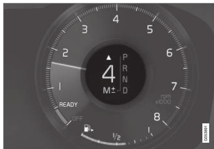
Schakelindicator op 12 inch bestuurdersdisplay*.
