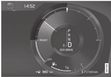
ECO-meter op 12 inch bestuurdersdisplay*.
