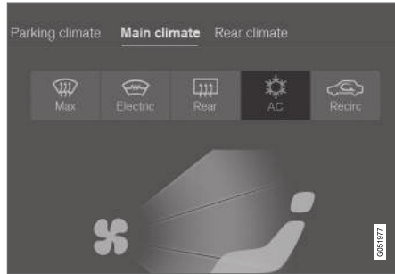
Airconditioningknop op klimaatscherm.
