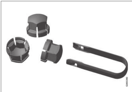
Demontagegereedschap voor kunststof boutafdekkingen.
