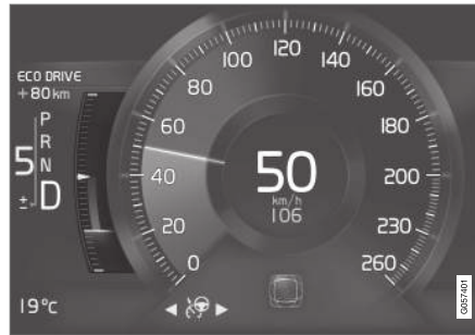
ECO-meter op 8 inch bestuurdersdisplay.
