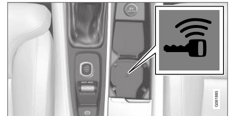
Positie back-uplezer in de tunnelconsole.
