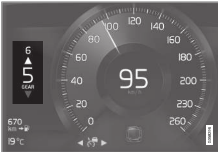
Schakelindicator op 8 inch bestuurdersdisplay.
