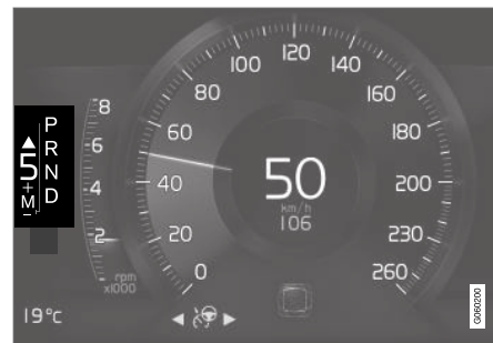
Schakelindicator op 8 inch bestuurdersdisplay.
