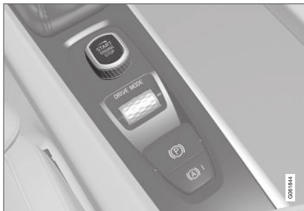
De startknop op de tunnelconsole.
