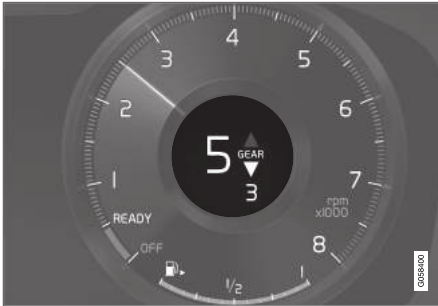
Schakelindicator op 12 inch bestuurdersdisplay*.
