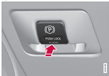
Comando do travão de estacionamento - aplicado.
