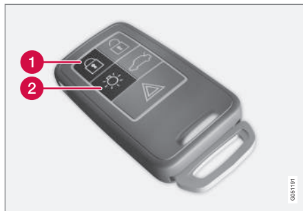
Boutons de la clé-télécommande utilisés pour le démarrage à distance du moteur
