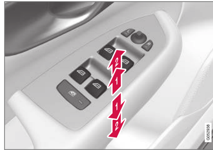
Fonctionnement des vitres électriques.
