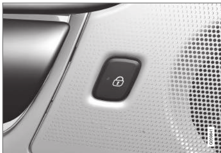
Låseknapp med indikatorlampe i bakdør.
