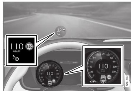
La figura precedente<sup>50</sup> mostra che il Pilot Assist è impostato per mantenere una velocità di 110 km/h (68 mph) e che non è presente un veicolo antistante da seguire.
