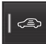
Premere il pulsante **Protezione ridotta** nella videata funzioni sul display centrale per disinserire i sensori di movimento e inclinazione al successivo bloccaggio dell'automobile.
