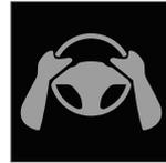
Se Pilot Assist rileva che il conducente non tiene le mani sul volante, un simbolo e un messaggio indicano al conducente di assumere il controllo dell'automobile.
