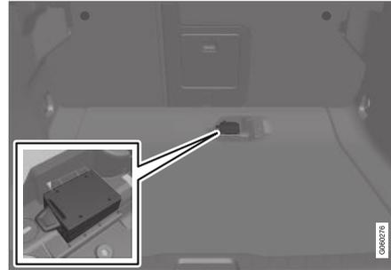
Inserire una SIM card personale nel supporto sotto il pavimento del bagagliaio.
