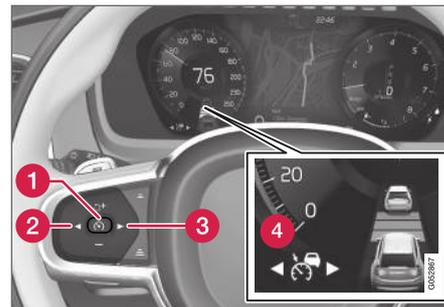
Direttamente dopo ciascuna accensione del motore, il Regolatore elettronico della velocità adattivo è nel modo di attesa. Per portarlo nel modo di attesa quando è attivato, procedere come segue:
