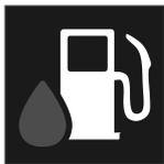
Quando il livello di AdBlue inizia ad abbassarsi, si accende un simbolo sul display del conducente e viene visualizzato il messaggio **Livello AdBlue basso**.
