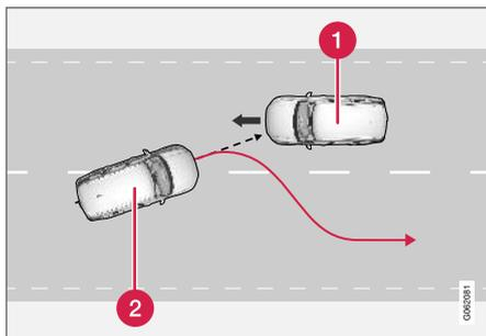
La funzione può assistere il conducente riportando l'automobile sulla propria corsia di marcia.
