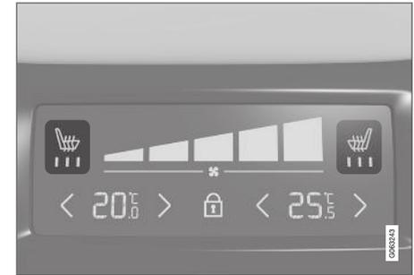
Indicatore del riscaldamento del sedile e comandi sul pannello del climatizzatore sul retro del tunnel.
