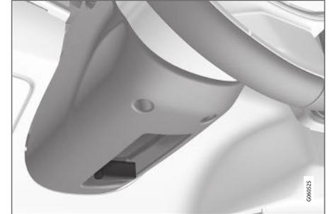
Leva per la regolazione del volante.
