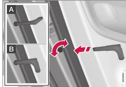
Fermo di sicurezza per bambini manuale. Da non confondere con il bloccaggio manuale della portiera.
