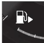
Con una freccia accanto al simbolo del serbatoio, il display del conducente indica il lato dell'automobile in cui si trova lo sportello del serbatoio.
