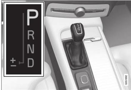
Il display del conducente segnala la posizione del cambio selezionata:
