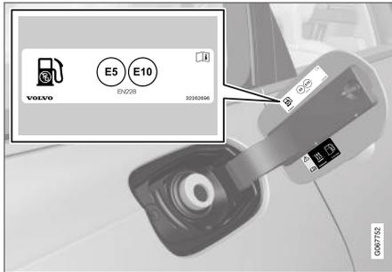
Utilizzare un carburante approvato per l'automobile, vedere l'identificatore<sup>15</sup> all'interno dello sportello del serbatoio. Per informazioni su carburanti approvati e identificatore, vedere la sezione "Benzina" o "Diesel".
