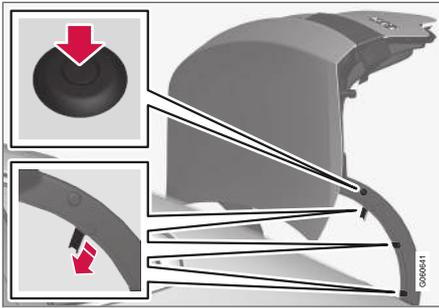
La protezione in plastica della cerniera è montata con un rivetto in plastica e tre fermi.
