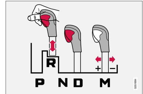
La leva può essere portata liberamente in avanti o all'indietro tra **N** e **D**. Le altre posizioni hanno un blocco che viene manovrato tramite il pulsante di bloccaggio sulla leva selettiva.
