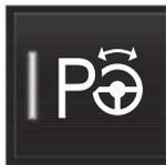
La funzione controlla in primo luogo se lo spazio è sufficiente, quindi assiste il conducente sterzando l'automobile finché non è parcheggiata correttamente.
