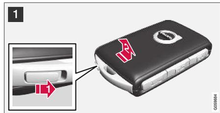
**1** **1** ➔ Tenere la chiave telecomando con il lato anteriore ben in vista e il logo Volvo orientato correttamente. Spingere verso destra il pulsante presso l'anello portachiavi sul bordo inferiore. Spingere il guscio del lato anteriore verso l'alto di alcuni millimetri.
