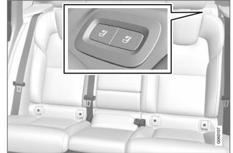
Pulsanti per il ripiegamento del sedile, ubicato sulla parte superiore sinistra del sedile posteriore.
