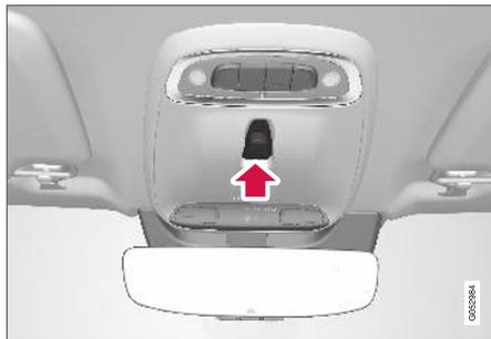
Il tettuccio apribile si aziona con un comando nel padiglione. Il comando si attiva quando il quadro dell'automobile è in posizione I o II.
