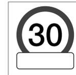
La visualizzazione di un cartello accessorio sotto forma di un riquadro vuoto sotto il segnale di velocità<sup>88</sup> sul display del conducente indica che la funzione ha rilevato un cartello accessorio con informazioni complementari per il limite di velocità attuale.
