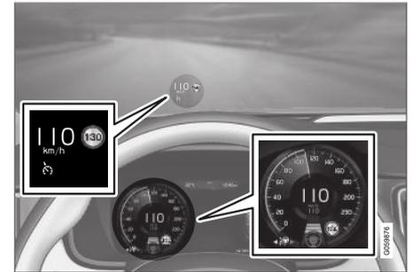
La figura precedente<sup>50</sup> mostra che il Pilot Assist è impostato per mantenere una velocità di 110 km/h (68 mph) e che non è presente un veicolo antistante da seguire.
