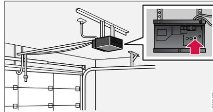
4. Localizzare il pulsante di apprendimento<sup>32</sup> del ricevitore, ad esempio del portone del garage. Solitamente si trova accanto all'attacco dell'antenna sul ricevitore.
