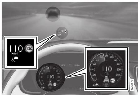
La figura precedente<sup>50</sup> mostra che il Pilot Assist è impostato per mantenere una velocità di 110 km/h (68 mph) e segue un veicolo anti-stante che mantiene la stessa velocità.
