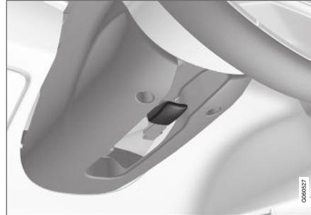
Leva per la regolazione del volante.
