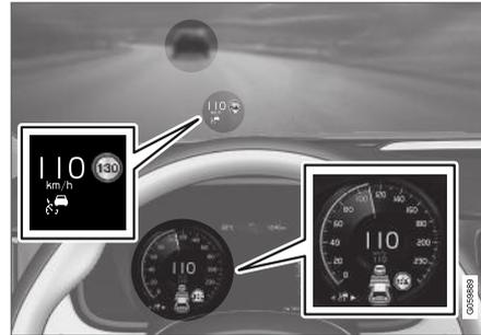
La figura precedente mostra che il Cruise adattivo è impostato per mantenere una velocità di 110 km/h (68 mph) e segue un veicolo antistante che mantiene la stessa velocità.
