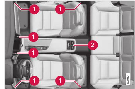
Posizione delle bocchette di ventilazione regolabili nell'abitacolo.
