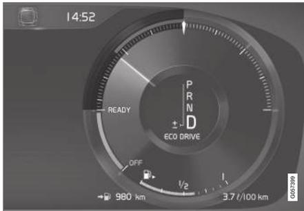
Misuratore ECO sul display del conducente da 12"\*
