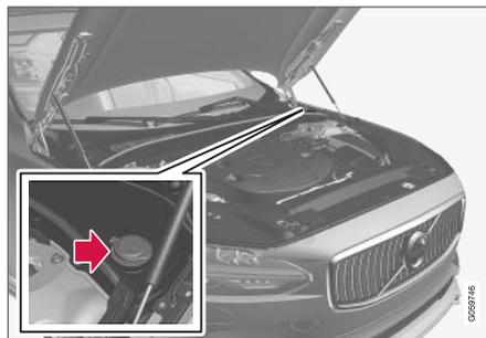
Il liquido lavacrystalli si rabbocca nel serbatoio con il tappo blu. Il serbatoio è usato sia per il lavaparabrezza che il lavafari\*
