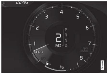
La posizione manuale del cambio può essere selezionata in qualunque momento durante la marcia. Rilasciando il pedale dell'acceleratore, si attiva il freno motore.
