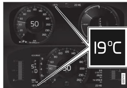
Posizione del termometro della temperatura esterna sul display del conducente da 12''\* e 8''.
