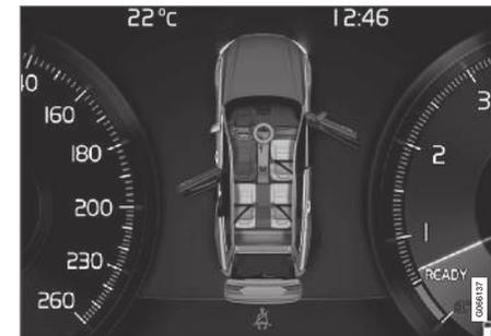
Grafica nel display del conducente con vari tipi di avvertimento. Il colore di segnalazione su portiera e baule varia a seconda della velocità dell'automobile.
