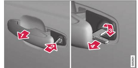
**1**▶ Portare al fincorsa esterno la maniglia della portiera anteriore sinistra<sup>9</sup>, mettendo a nudo la serratura.
