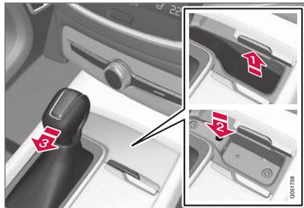
Se non è possibile guidare l'automobile, ad esempio perché la batteria è scarica, occorre portare la leva selettore in posizione **N** per spostare l'automobile.
