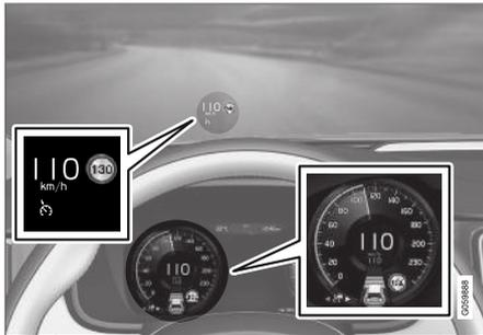
La figura precedente mostra che il Cruise adattivo è impostato per mantenere una velocità di 110 km/h (68 mph) e che non è presente un veicolo antistante da seguire.
