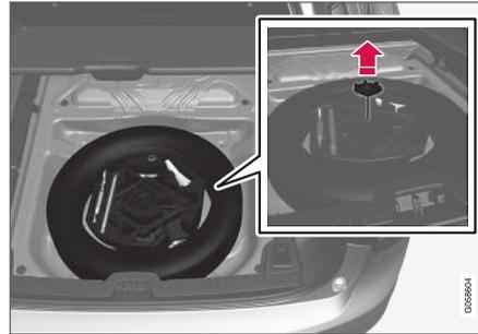
La ruota di scorta è sistemata nel relativo alloggiamento con la parte esterna rivolta verso il basso. La ruota di scorta e il blocco in schiuma sono tenuti in posizione dalla stessa vite passante. Il blocco in schiuma contiene tutti gli attrezzi per la sostituzione delle ruote.
