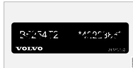
4 Etichetta per codice motore e numero di produzione del motore.
