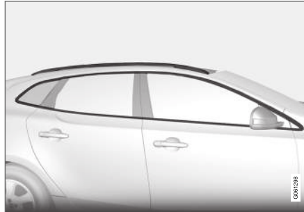
Alkatrészek, amelyek 3,5 és 11,5 pH-érték közötti tisztítószerrel moshatók.
