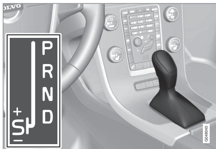
D: Cambios de marcha automáticos. +S- : Cambios de marcha manuales. S: Modo Sport*.
