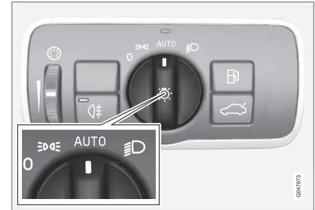
Verlichtingsdraaiknop in stand AUTO .
