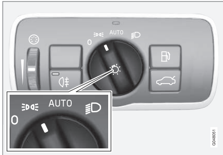
Verlichtingsdraaiknop in stand voor stadslichten vóór en achterlichten.
