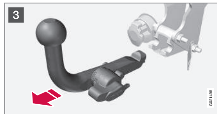
3 Draai de vergrendelingsknop volledig omlaag totdat deze niet verder kan. Houd de knop in deze stand vast terwijl u de trekhaak schuin naar achteren toe omhoogtrekt.
