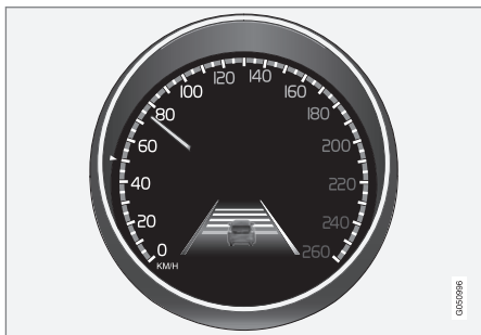
Zijlijnen van LDW-systeem.
