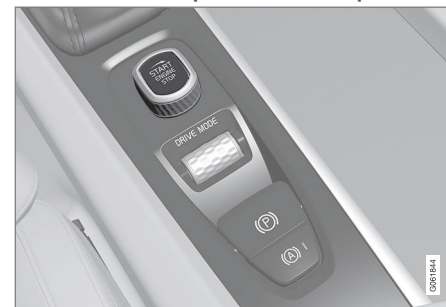
Interruttore di avviamento nel tunnel.
