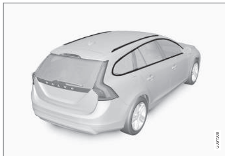
Onderdelen die moeten worden schoongemaakt met een reinigingsmiddel met een pH tussen 3,5 en 11,5.
