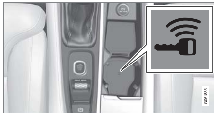
備用讀取器位於中央扶手控制台中。
