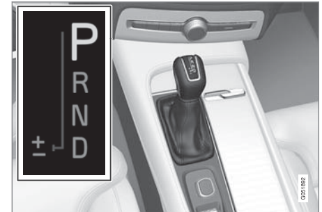
ภาพรวมของคันเกียร์ขนาดใหญ่และรูปแบบการเปลี่ยนเกียร์ในจอแสดงผลสำหรับคนขับ
