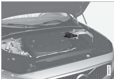
แบตเตอรี่สำรอง 12 โวลต์ จะอยู่ในช่องถัดจากหลักค้ำใช้ค
