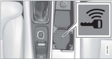
ตำแหน่งของตัวอ่านคีย์รอนในคอนโซลบริเวณโพรงเพลากลาง
