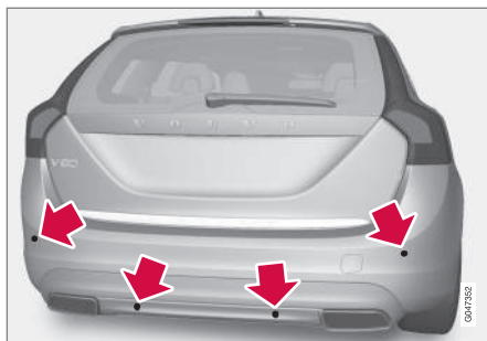
Posizionamento dei sensori posteriori.
