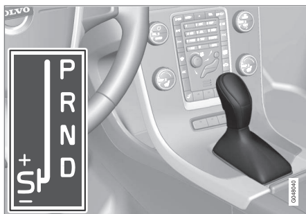
D: Posizioni del cambio automatico. +/-: Posizioni del cambio manuale. S 6 : Modalità Sport*.
