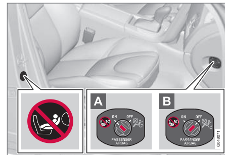
Posizione dell'etichetta e del commutatore dell'airbag.
