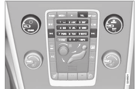
Telefoonfuncties, overzicht bedieningselementen.
