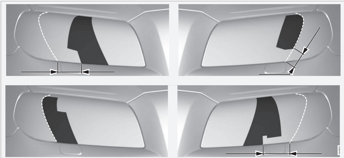
Øverste rad: Bil med venstreratt, malene A og B. Nederste rad: Bil med høyerratt, malene C og D.
