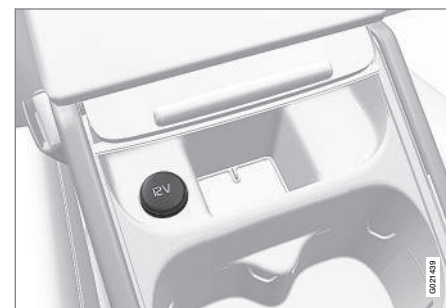
12 V-uttak i tunnellkonsoll, forsete.
